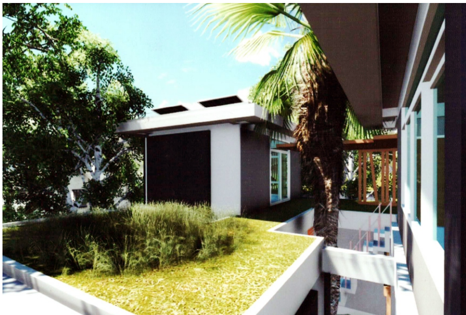
ภาพที่ 4-15 หลังคาเขียวบ้าน “Under Tree” โดยมีคอร์ทกลางบ้าน เพื่อการไหลของลม ตามแนวคิดในภาพที่ 4-16
