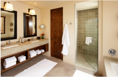
ภาพที่ 3-21 การใช้ประตูห้องน้ำแบบปิดทึบ เพื่อป้องกันความชื้นจากห้องน้ำรั่วไหลสู่พื้นที่ปรับอากาศ
