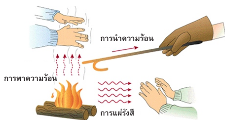
ภาพที่5-6 การถ่ายเทความร้อนด้วยวิธีต่างๆ (Heat Transfer) การพาความร้อน คือ การถ่ายเทจากที่หนึ่งไปยังอีกที่หนึ่ง โดยมีตัวพาความร้อน เช่นลม, การนำความร้อน คือ การถ่ายเทจากที่หนึ่งไปที่หนึ่ง โดยมีตัวนำ เช่น ของแข็ง และการแผ่รังสีเกิดจากการแผ่รังสีของตัวต้นกำเนิดเช่น ดวงอาทิตย์แผ่รังสี
